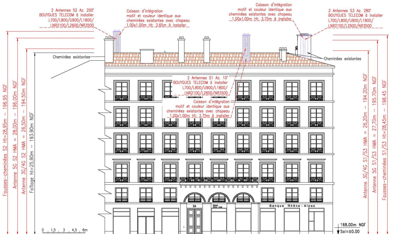
PLAN EN ELEVATION DE L'INSTALLATION BOUYGUES TELECOM
